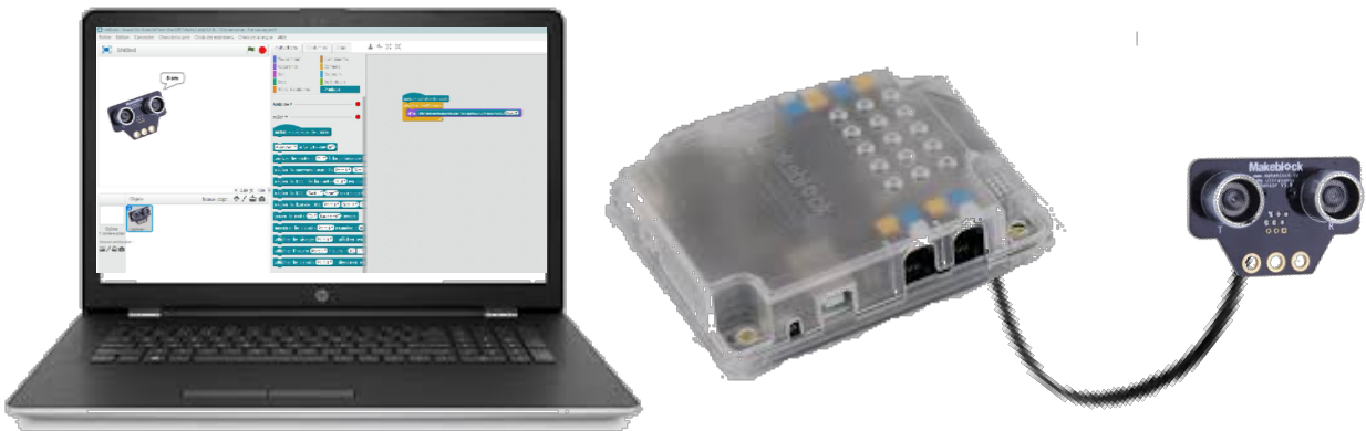
Exemple de mesure de distance à l'aide du capteur ultrason
